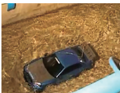
氾濫時の車の漂流に関する水理実験 Hydraulic experiment of floating car in flooding
