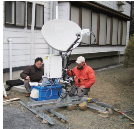
衛星通信を使ったリアルタイムデータ伝送 (東北地方太平洋沖地震緊急余震観測) Telemeter observation using the satellite data link.
