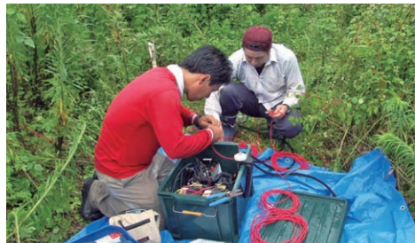
電磁気探査システムの設置 Set up an electromagnetic survey system
