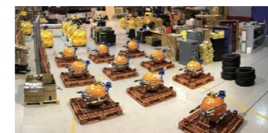
GNS Science での準備作業。オレンジ色の機材は日本チームの海底地震計、黄色の機材はNZチームの海底圧力計です。
