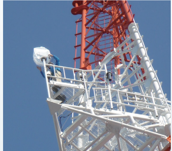
写真2 地上40 mのデッキで超音波風速計に袋をかぶせ、無風状態での値を点検している筆者の様子（技術職員さん撮影）。
