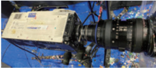
図1 ドイツのZEISSのシネマレンズがついたNACのハイスピードカメラMEMRCAM HX-3
