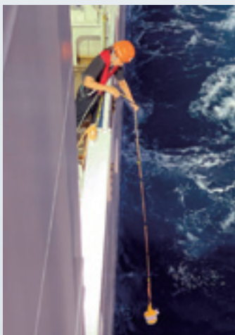
図1 トランスデューサーの投入。ノイズ対策として、側面を白い布に包まれています（日向灘における学生実習の1コマ）
