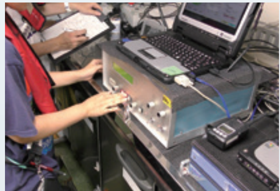
図2 音響通信装置（四角い箱）。PCとシリアル通信をして様々なコマンドを送信します。この写真は切り離しコマンドを送信しています。
