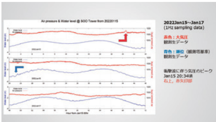
図2 観測塔で観測された気圧、水位の時系列(2022年1月15日～17日)
