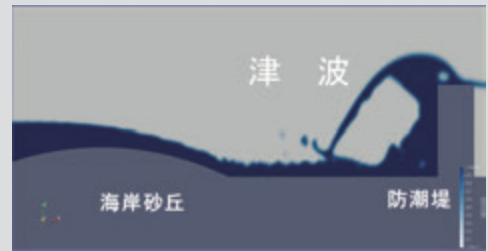
砂丘背後の防潮堤に作用する津波の様子 (OpenFOAMによる)
