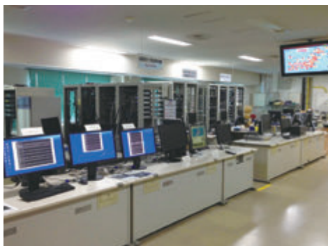
テレメータ装置室、ここに日本各地の地震観測記録や地殻変動連続観測記録が オンライン・オフラインで集まる The telemeter room: Online and offline data from observation networks for earthquakes and crustal deformation are processed
