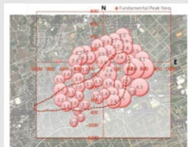
熊本県益城町での微動のピーク 振動数分布 Peak frequency distribution at Mashiki, Kumamoto
